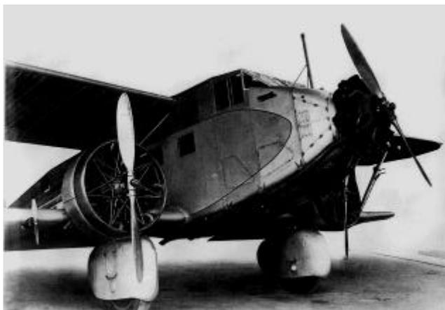
Prototype du Breguet 390 T à trois moteurs Gnome & Rhône 5 Kd Titan de 240 ch. C'est sur cette machine que le pilote Bucquet trouva la mort le 3 juillet 1931. (Catalogue Breguet).
