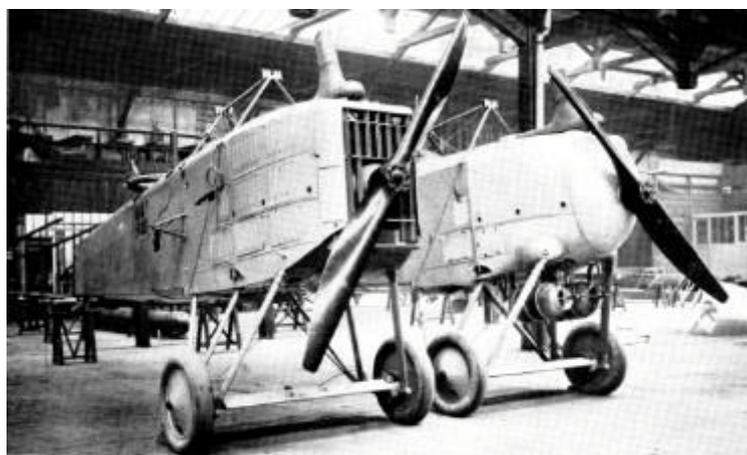
Un Breguet 14 avec radiateur classique à gauche et avec radiateurs Lamblin à droite. Gain : 20 km/h. (Collection A. Marchand).
