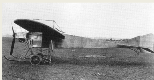
Vickers n° 7 à moteur 100 ch Gnome à 14-cyl, hélice tripale et train modifié. Cette machine n'a plus rien à voir avec le REP d'origine. (Brooklands Museum).
