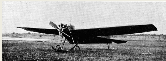
Monoplan REP type A à une place à moteur 5-cyl 50/60 ch fin 1910. (L'Aérophile).
