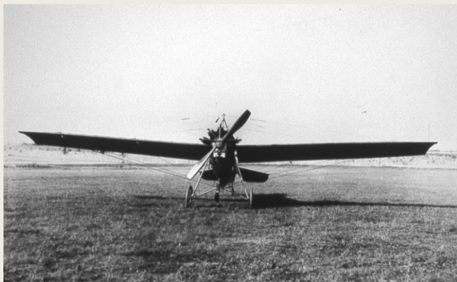
Monoplan REP type B militaire à moteur REP de 90 ch. (Archives municipales de Boulogne-Billancourt).
