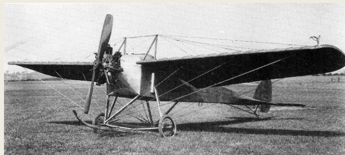
Le Vickers n° 6 à moteur Viale (1912) présente déjà par rapport au REP de base des modifications importantes. (Brooklands Museum).
