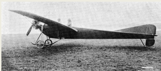
Monoplan REP à deux places, type militaire, à moteur 5-cyl de 50/60 ch, fin 1910. (L'Aérophile).
