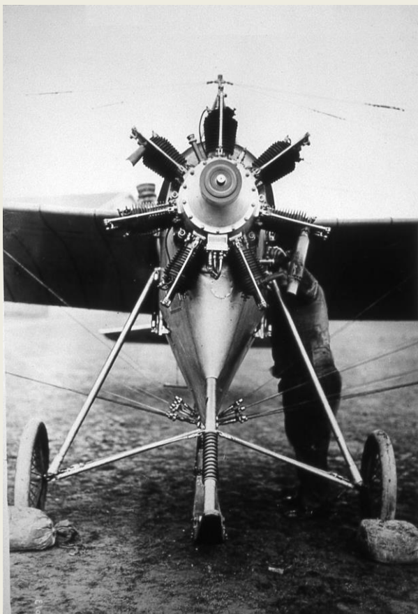
Moteur REP de 90 ch monté sur un REP type B. (Archives municipales de Boulogne-Billancourt).
