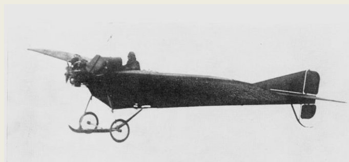
Le R.E.P. type D biplace à moteur Gnôme 80 ch (1910). (Musée de l'Air).
