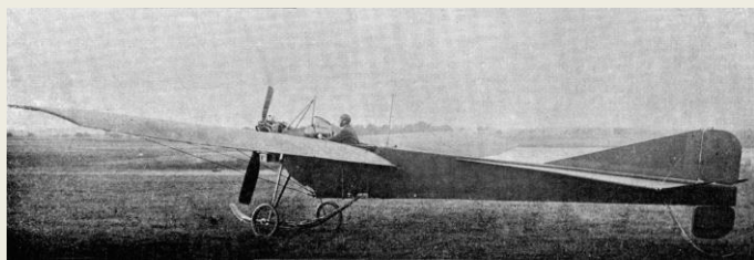
Monoplan REP type A à moteur 50/60 ch, fin 1910. (L'Aérophile).
