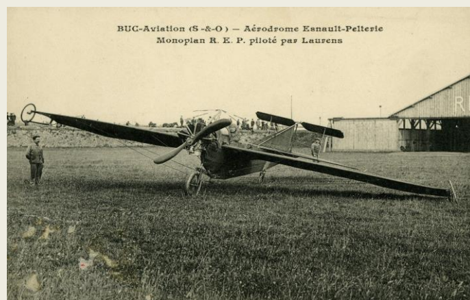
Moteur REP à 7-cyl en éventail de 35 ch et hélice quadripale REP montés sur le REP n° 1. (Archives municipales de Boulogne-Billancourt).
