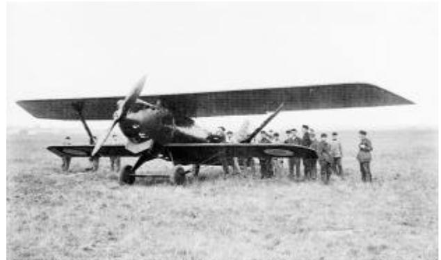
*Breguet 19 à voilure agrandie type Grands Raids (1926). La plupart de ces machines furent équipées de moteurs Hispano-Suiza V12 de 600 ch. (Musée de l'Air).*
