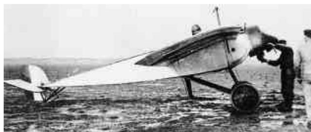
**Morane-Saulnier type E** montrant la forme du plan vertical de queue, le plan monobloc horizontal de queue et le profil de l'aile (1912).
