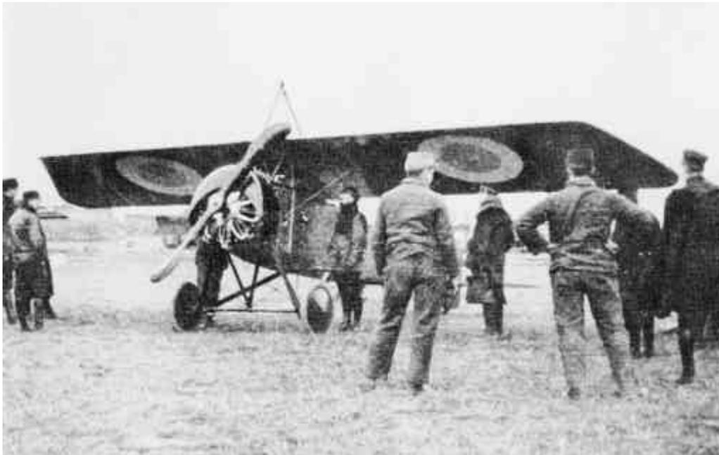
***Mobilisé dans l'aviation au Bourget en octobre 1914, Garros met au point le tir à la mitrailleuse à travers le champ de l'hélice sur le Morane-Saulnier type L à voilure « parasol ». Fixée sur la capot, la mitrailleuse tirait à travers le cercle balayé de l'hélice, des coins métalliques déviant les balles des pales en bois de l'hélice.***
