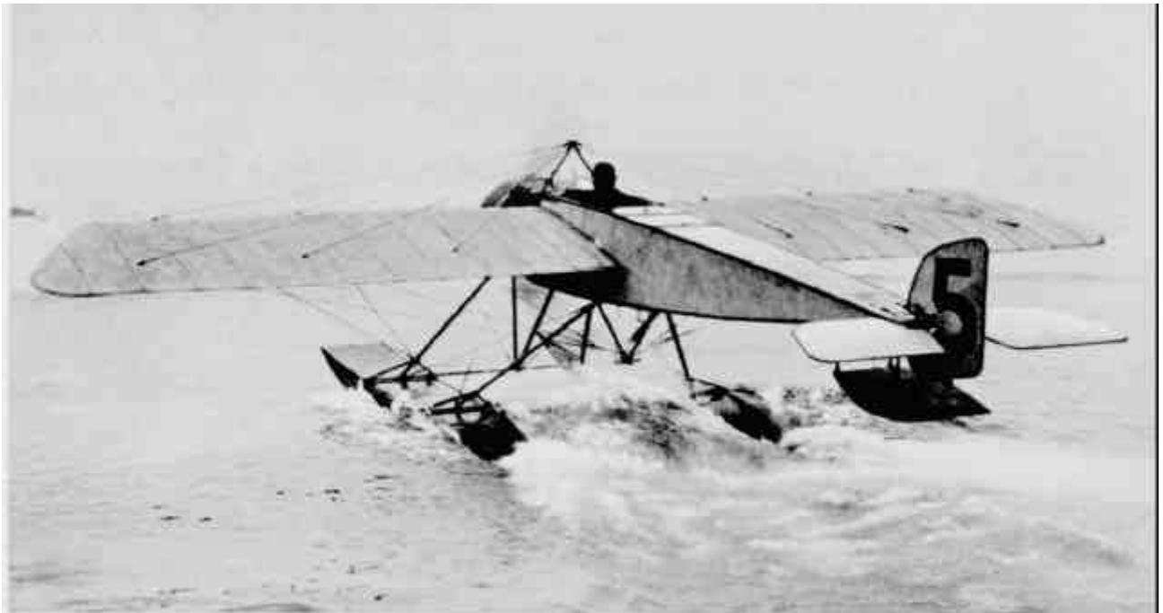
*Une cellule de 170 kg, 130 kg de jambes de train et flotteurs, 125 kg de moteur et réservoir, 70 kg de poids du pilote et 50 kg d'essence, tel se présente en 1913 le Morane-Saulnier hydro, piloté ici à Monaco par l'excellent Roland Garros.*
