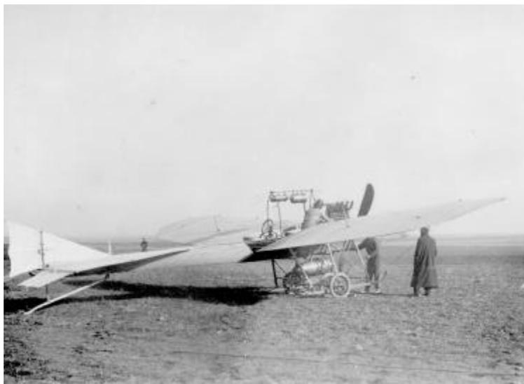
*Appareil Hanriot type VIII à moteur Clément-Bayard 100 ch (1911). (Collection M-H Clerget).*
