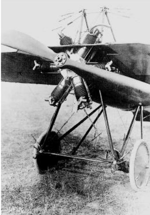
Le monoplan type B 1911 à moteur Anzani 60 fut le type le plus fabriqué en France avec trente exemplaires.
