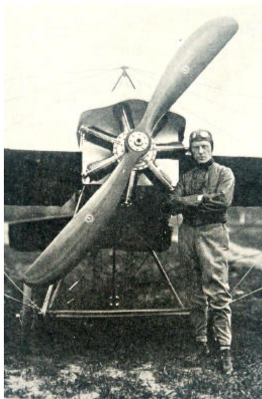
**Moteur Gnome 80 ch avec son hélice Chauvière de 2,10 m vissée sur le porte-hélice. (La Vie au grand air).**
