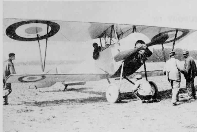
Biplan typique de 1914, le Nieuport type 10 volait à 140 km/h avec un moteur Le Rhône 9C de 80 ch. (MAE).
