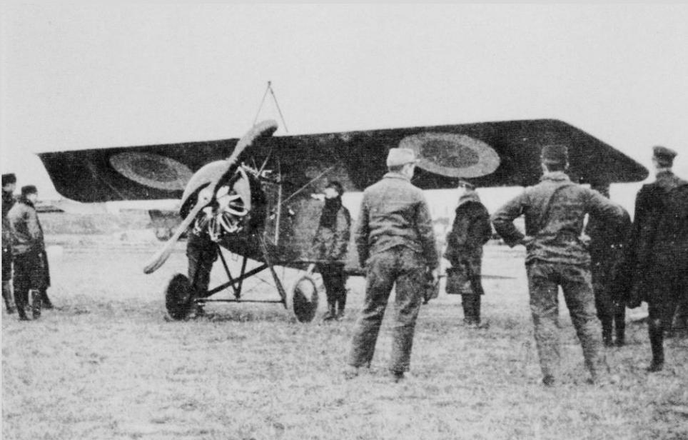
Morane-Saulnier historique : le type L aux pales comportant des déflecteurs et une mitrailleuse Hotchkiss tirant vers l'avant à travers de champ de l'hélice (décembre 1914). (L'Illustration).
