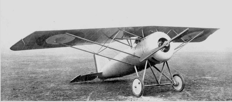
Chasseur Morane-Saulnier AI à moteur Gnome 9N à 9 cylindres rotatif de 165 ch construit à 1 200 exemplaires en 1917 et 1918. (MAE).
