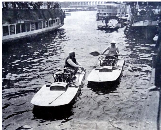
Les deux Ricochet-Nautilus au départ de la course de Paris à la mer 1907 au pont de Neuilly. Moteur Antoinette V8 de 30 ch. (LFA).
