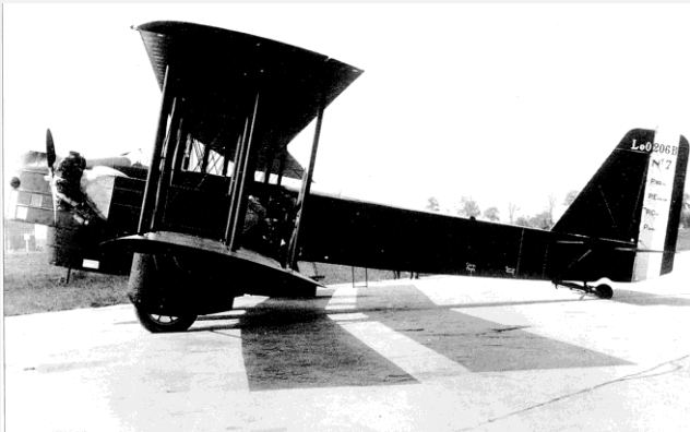
Bombardier Lioré et Olivier LeO 206 Bn4 , quatre moteurs Gnome & Rhône 7-cyl série K, 1932. (Collection A. Delmas).
