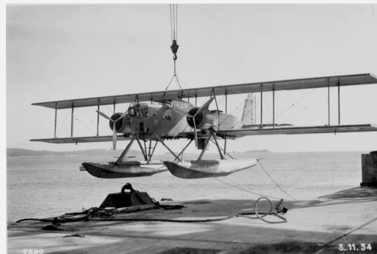
Hydravion de la Marine LeO H-257bis à Antibes, hissé à la grue de 40 tonnes, pendant ses essais officiels. (Collection Arnaud Delmas).
