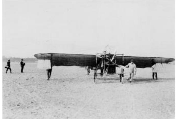
*Le Blériot VIIIbis photographié à Issy-les-Moulineaux le 2 juillet 1908, avant un vol. On voit bien l'aile droite, les ailerons, et l'hélice à quatre pales. (Musée de l'Air).*
