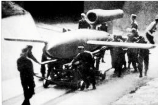
La bombe volante Fieseler-103, arme de représailles n° 1 (1943).
