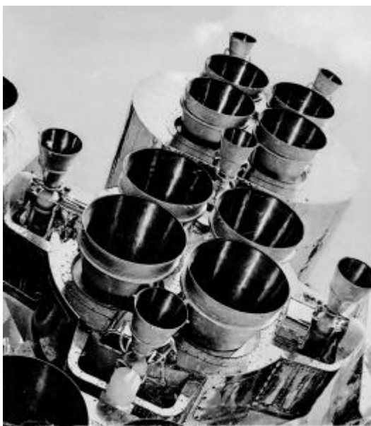
La fusée R-7 est un assemblage de moteurs de 25 tonnes de poussée issus de la V-2 allemande.
