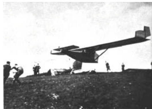
Le planeur type canard équipé d'un moteur fusée Sander, piloté par Fritz von Opel à Rhön, le 30 septembre 1928.
