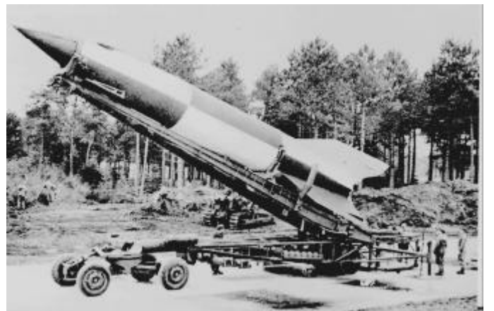
Fusée V-2 sur son véhicule mobile de tir.
