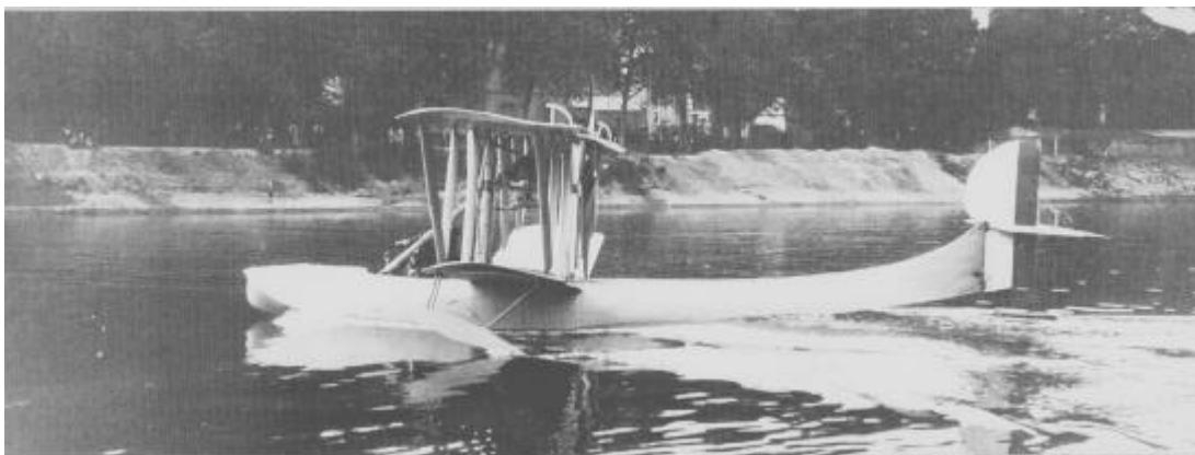
Prototype de l'hydravion Tellier 200 ch à moteur Hispano-Suiza photographié sur le Seine à Levallois-Perret pendant l'été 1916. (Cliché Musée de l'Air).
