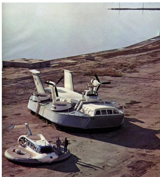
Les Naviplanes N102 (13 passagers) et N300 (100 passagers) Bertin de la SEDAM, 1965. Leur construction est faite par des sociétés aéronautiques : Breguet, Sud-Aviation, Snecma et Turboméca. (USIAS).
