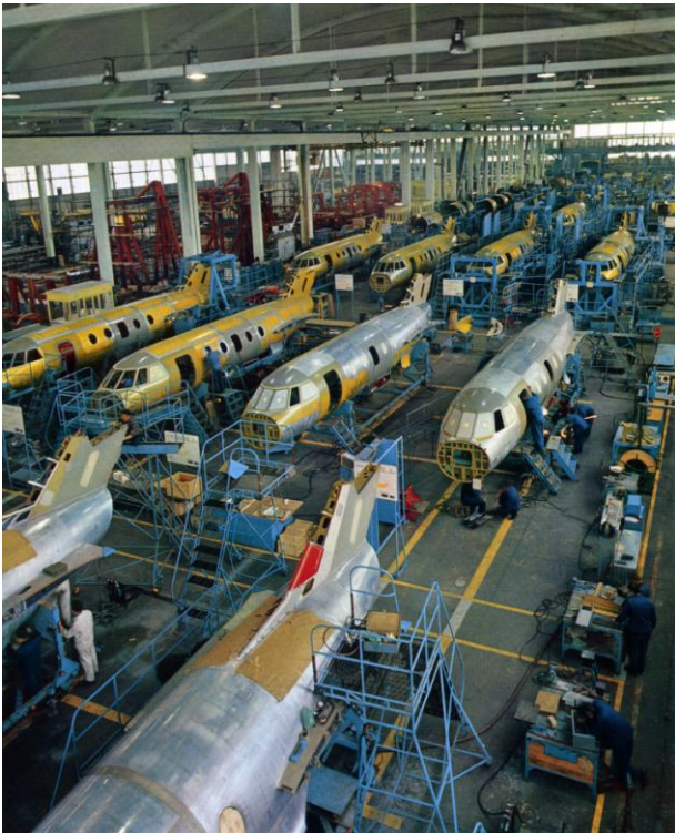
Atelier de montage des fuselages des Dassault « Fan Jet Falcon » 20 à Saint-Nazaire chez Sud-Aviation, 1967. Sud-Aviation participe aussi à la fabrication des Mirage III et Mirage IV. Pour sa part, Dassault produit encore en 1967 le Mirage 5, commandé en série, le Mirage F1, commandé en série, les Mirage F3, G et III-V (décollage vertical) étant à l'étude. L'Etendard IV M est encore en fabrication. Sud-Aviation en sous-traitance produit également des parties de Breguet « Atlantic ». (Document USIAS).
