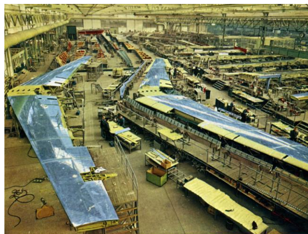
Assemblage des ailes de Caravelle à Nantes-La Bouguenais, 1960. (USA).
