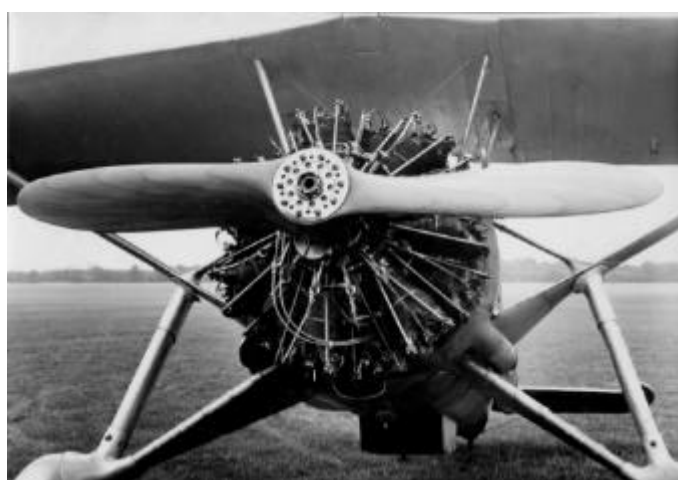
L'avion est impressionnant, et son 400 ch Diesel à 14-cyl tout autant. Moteur 14 E de 400 ch monté sur un MS-278.
