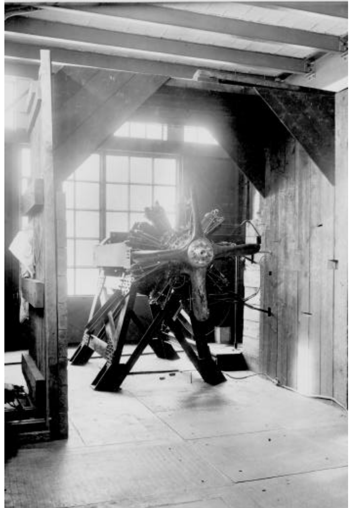
Première homologation d'un moteur à huile lourde français à 300 ch en 1932, le 9C du STAé. Le moteur pèse 330 kg et consomme 180 grammes par cheval et par heure de gasoil. (Collection Clerget).
