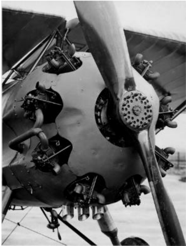
Moteur à huile lourde 9A de 100 ch monté sur un appareil d'essais MS-135 appartenant au STAé, 1929. (Archives Clerget).
