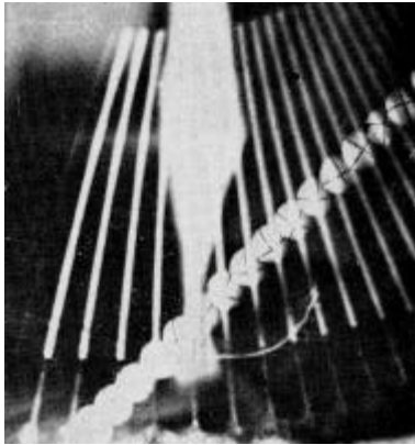
Stroborama A13/B13 départ d'une balle de golf. Cadence 1500 images par seconde. L'image a permis de calculer la vitesse de translation, 45 m/s et la vitesse de rotation de la balle sur elle-même 200 t/s.
