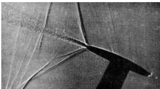
Stroborama G13 ondes de choc autour d'une aile à vitesse supersonique sur bras tournant.
