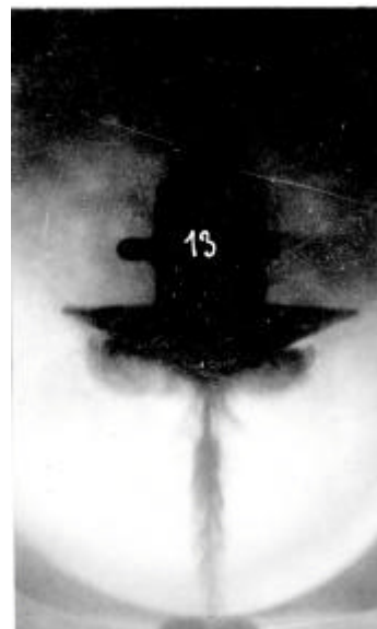
Photographie d'une injection, prise au Stroborama au STAé en 1923. (Archives STAé).
