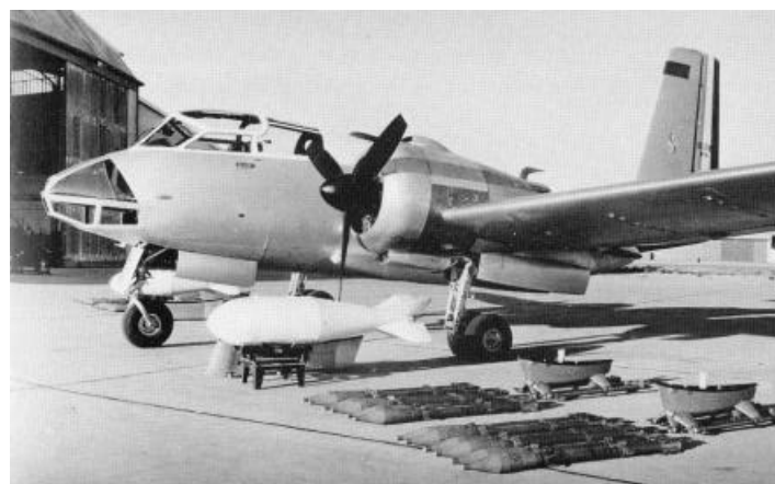
Le SE-116 « voltigeur » version à moteurs Wright présentée avec différentes charges extérieures, été 1958.
