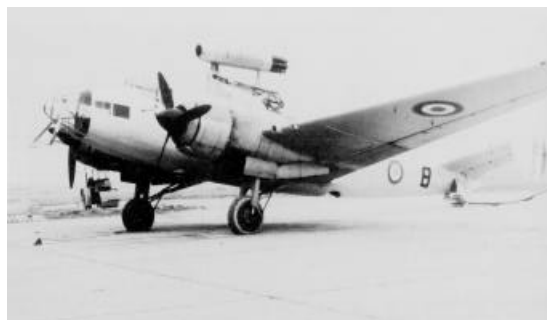
La SNECMA a utilisé un LeO-45 de 1946 à 1952 pour la mise au point de ses moteurs et pour celle des réacteurs, comme ici les pulsoréacteurs de l'Escopette, en 1951. (Cliché SNECMA).
