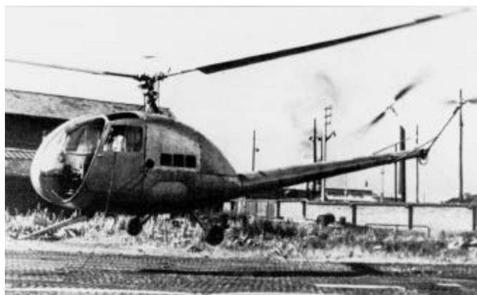
Le SE-3110 en juin 1950, avec ses deux rotors de queue, aux mains de Jacques Lecarme. (Cliché Musée de l'Air).
