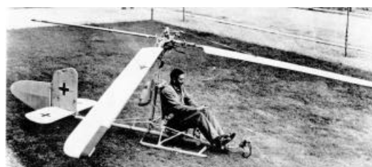
L'autogyre Focke-Achgelis 330 fut utilisé en 1942 par la marine de guerre allemande sur sous-marins. (Archives Focke-Wulf).
