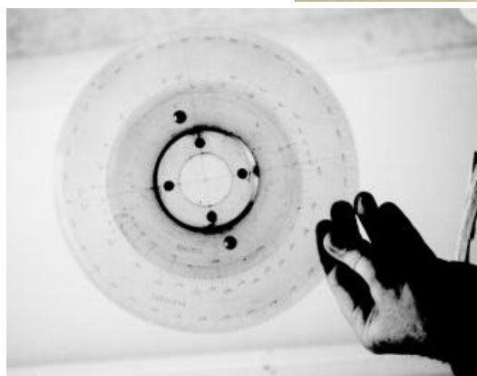
Règle à calcul imaginée et réalisée par André Violleau pour la génération des angles le long de la coque (Eliane Hartmann).
