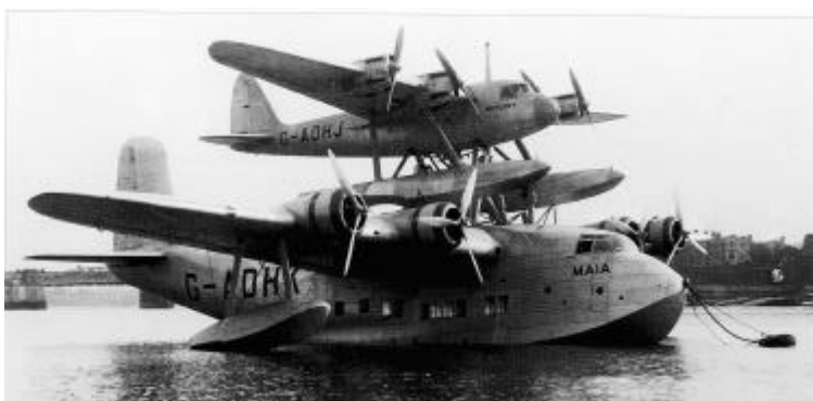
Le complexe d'hydravions Short « Maïa » (porteur) et « Mercury » (hydravion porté) en 1938.
