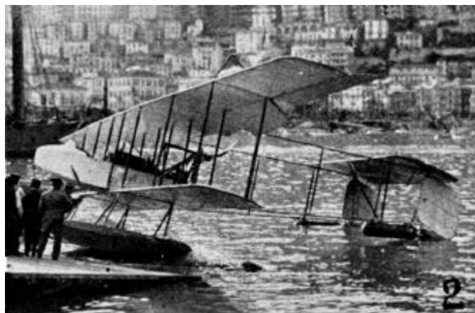
Monaco 1913 a vu l'élimination de solutions trop compliquées comme cette transmission par arbre ( M-Farman-Renault V12 ).
