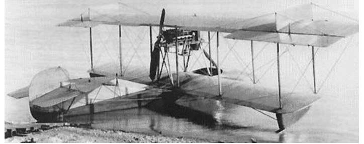
Le Curtiss type F est un vrai hydravion à coque. Son moteur développe de 85 à 130 ch. (Cliché N.A.S.M.).
