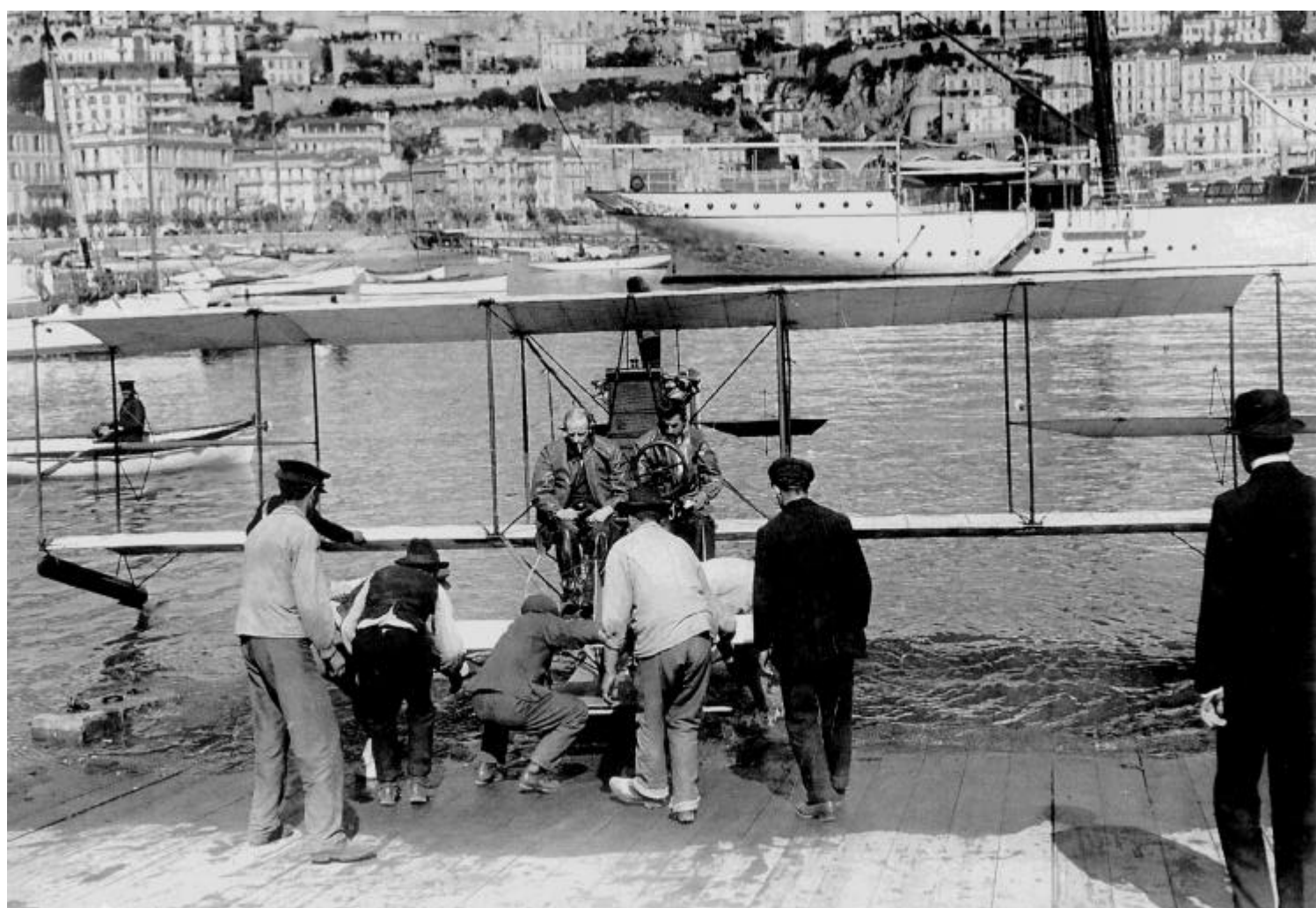
L'hydro aéroplane Paulhan-Curtiss à Monaco en 1912, lors des réglages de son stabilisateur avant, effectué sous les yeux de Louis Paulhan, à l'extrême droite de la photo. (Cliché Musée de l'Air).
