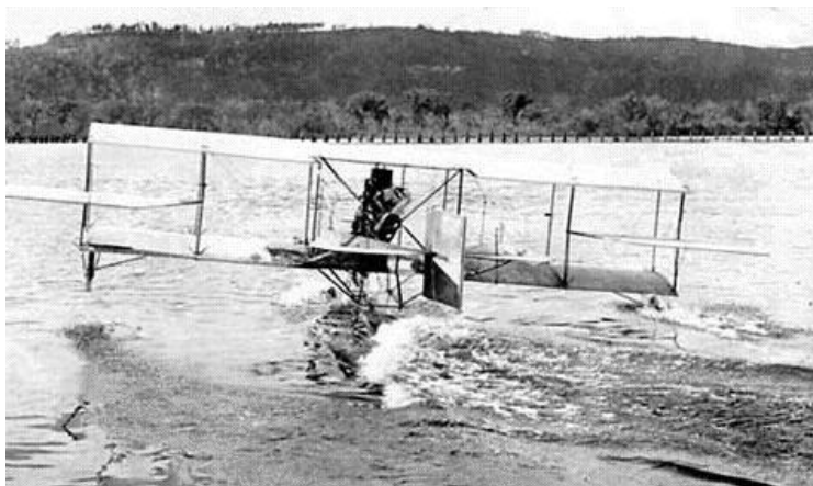
L'hydro aéroplane Paulhan-Curtiss type E (1912) aux essais dans la baie de San Diego. (Cliché Aerofiles).
