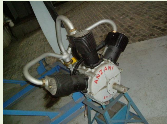
Moteur Anzani de 24-25 ch, musée royal des armées Bruxelles. (Photo de l'aute'r).
