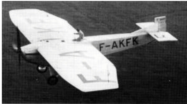
Le Farman 1000 en juillet 1932. Le pilote doit décoller assis sur la carlingue (il dispose d'un manche spécial) puis se glisser à l'intérieur du cylindre étanche. (MAE).
