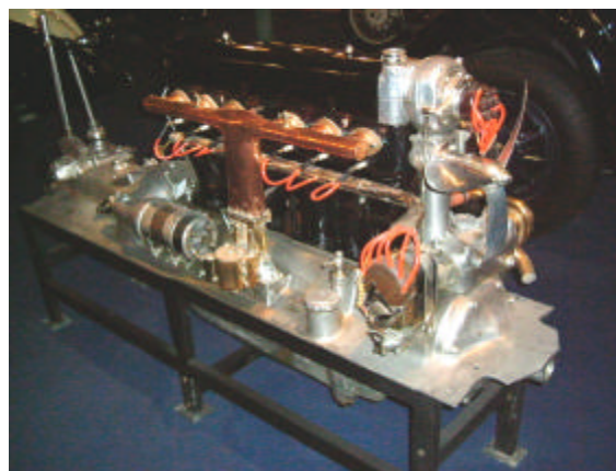
Le moteur 6-cyl Farman d'automobile (1927) est un demi-moteur V12 d'aviation. (Musée automobile de Mulhouse).
