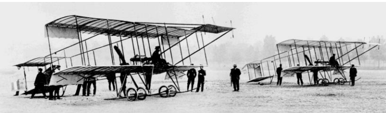
Les deux premiers avions achetés par l'Armée, livrés début 1910, des biplans Farman à moteur Gnome 50 ch.
