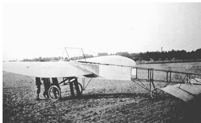
Le Blériot « militaire » est un monoplane renforcé de 8,45 m de long, deux places en tandem ou côte à côte, 18 m 2 de surface portante, 530 kg en charge, qui vole à 100 km/h avec le Lambda de 80 ch. (Cliché Blériot).
