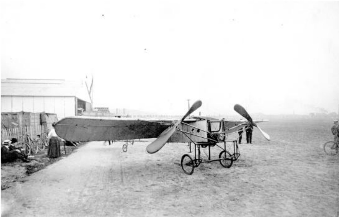
Le monoplan Lioré dans sa version 1910 avec un moteur provisoire à Issy-les-Moulineaux. On peut constater que les ailerons occupent tout le bord de fuite de l'aile. (Collection Arnaud Delmas).
