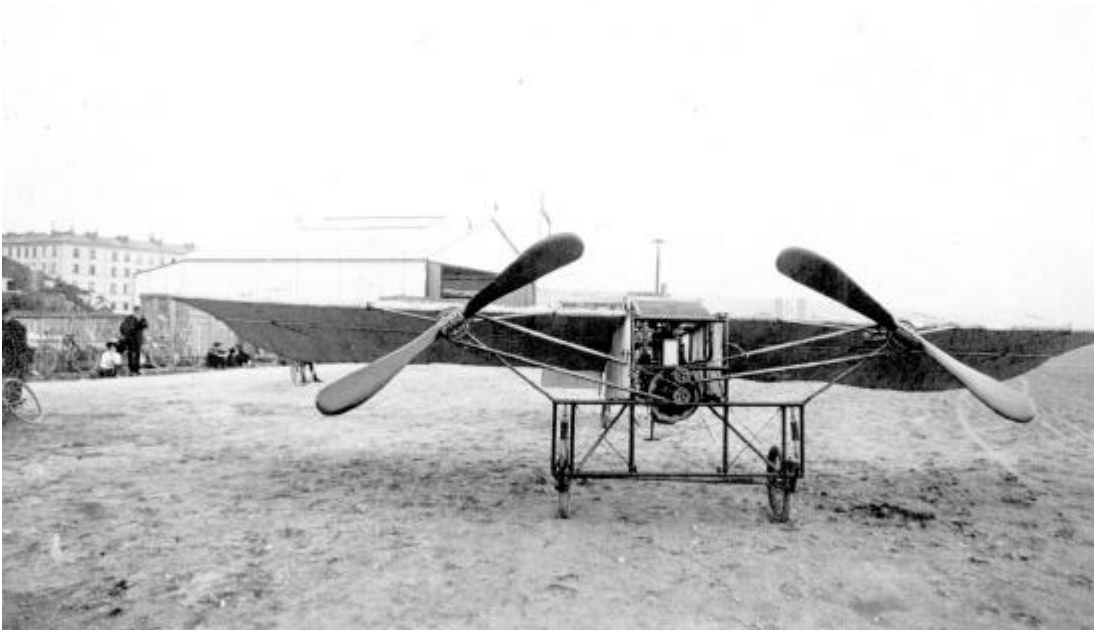
Le monoplan Lioré dans sa version 1910 à Issy-les-Moulineaux. Les roues tirées du train sont amorties par sandow. (Collection Arnaud Delmas).
