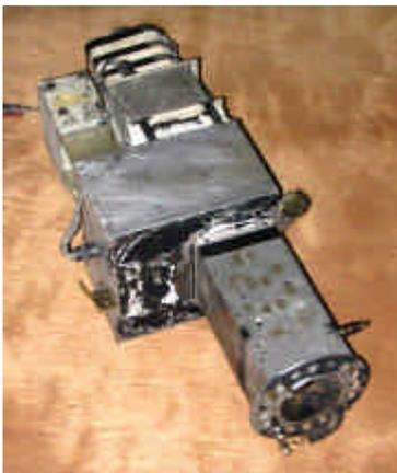
**Le spectropolarimètre de bord. Un système automatique permet le déclenchement quand l'astre est dans le champ de visée. (OPM).**
