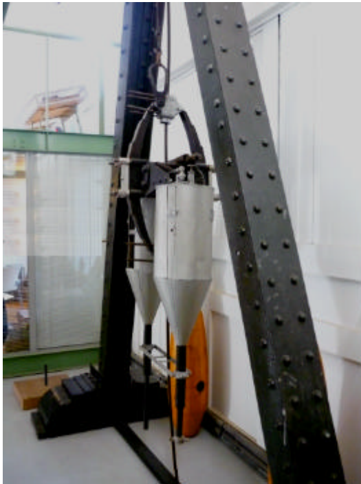
La machine de chute au laboratoire aérodynamique Eiffel rue Boileau, état actuel. (Cliché de l'auteur).
