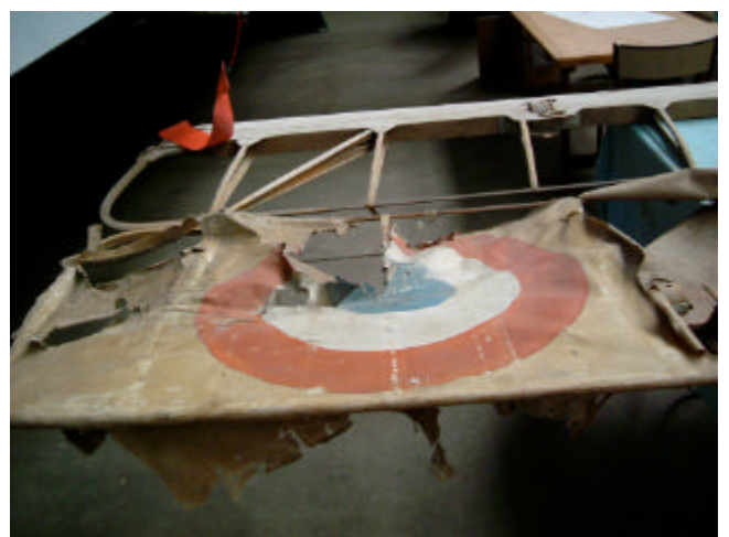
Plan inférieur d'aile du Nieuport 26 (ou identifié comme tel) du CAEA, état août 2003.
