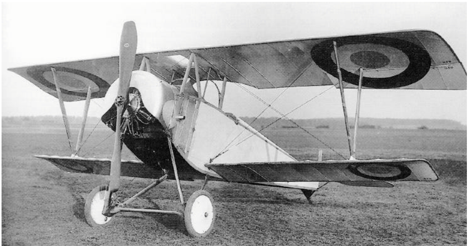
Le premier Nieuport 10 de série, un biplace d'observation armé (une mitrailleuse sur l'aile) à moteur Le Rhône 80 ch, avec poste de pilotage à l'avant et mitrailleur à l'arrière, début 1915.
