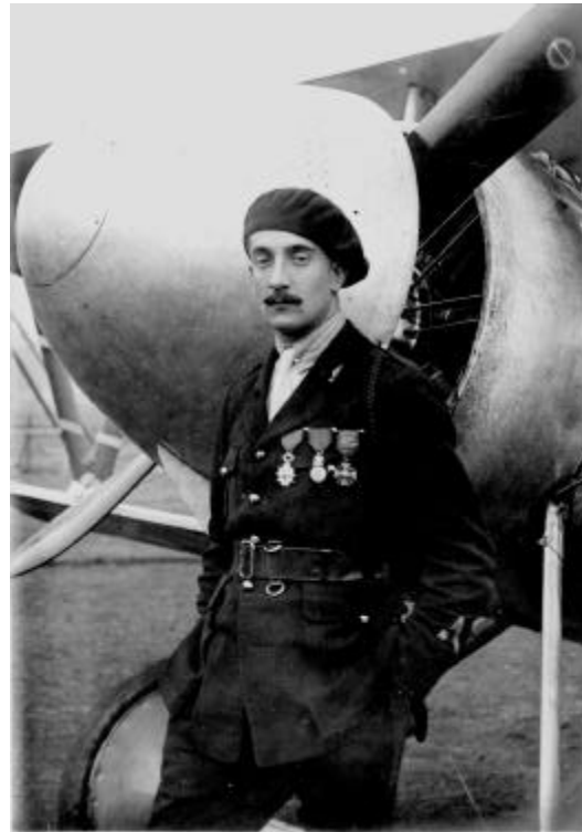
Flachaire devant son Nieuport 17bis à hélice carénée dont l'entrée d'air est obturée, ce qui améliore sans doute la vitesse maxi mais ne permet pas au moteur de bien refroidir.
