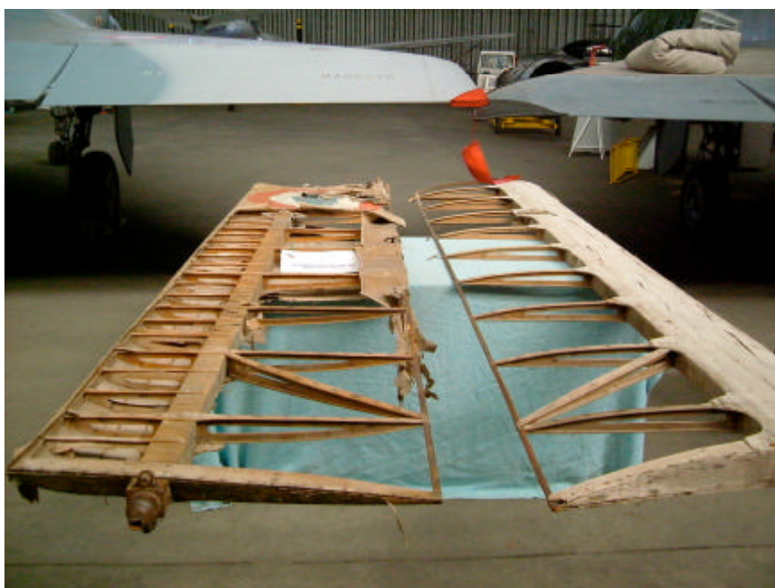
Aile inférieure d'un Nieuport de chasse en cours de restauration au CAEA, août 2003. On voit la technique de fabrication.
