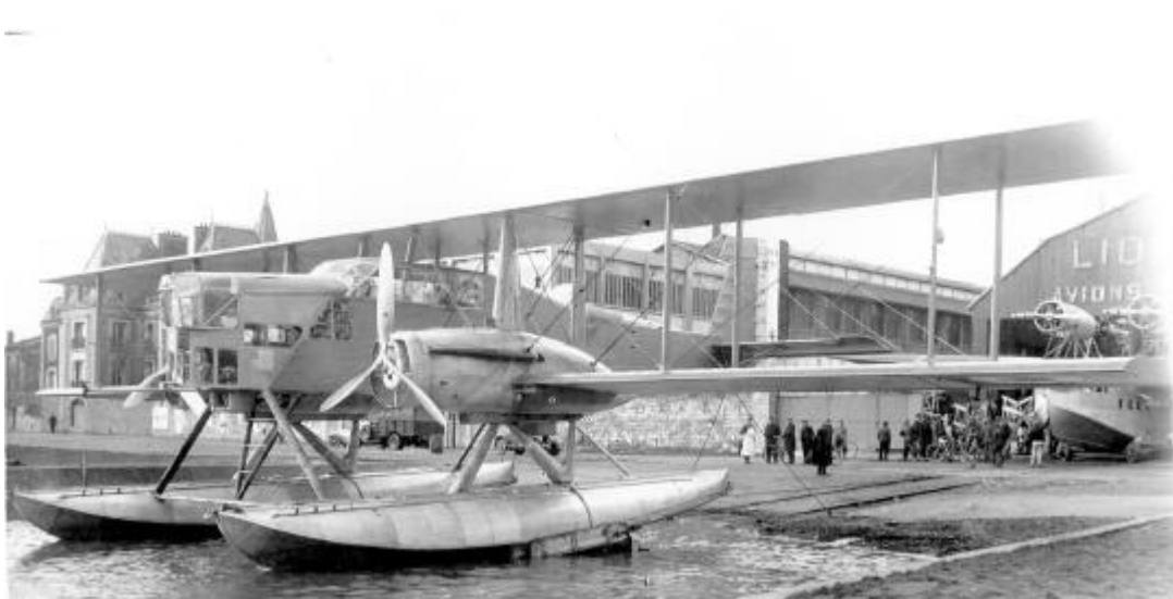
Qualifié de « cathédrale volante », le beau LeO H-259 à moteurs Hispano de 860 ch sur son slip à Argenteuil devant un hydravion de transport LeO H-24 (collection Arnaud Delmas).
