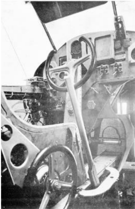
LeO H-257 poste de pilotage principal. (Coll. A. Delmas).
