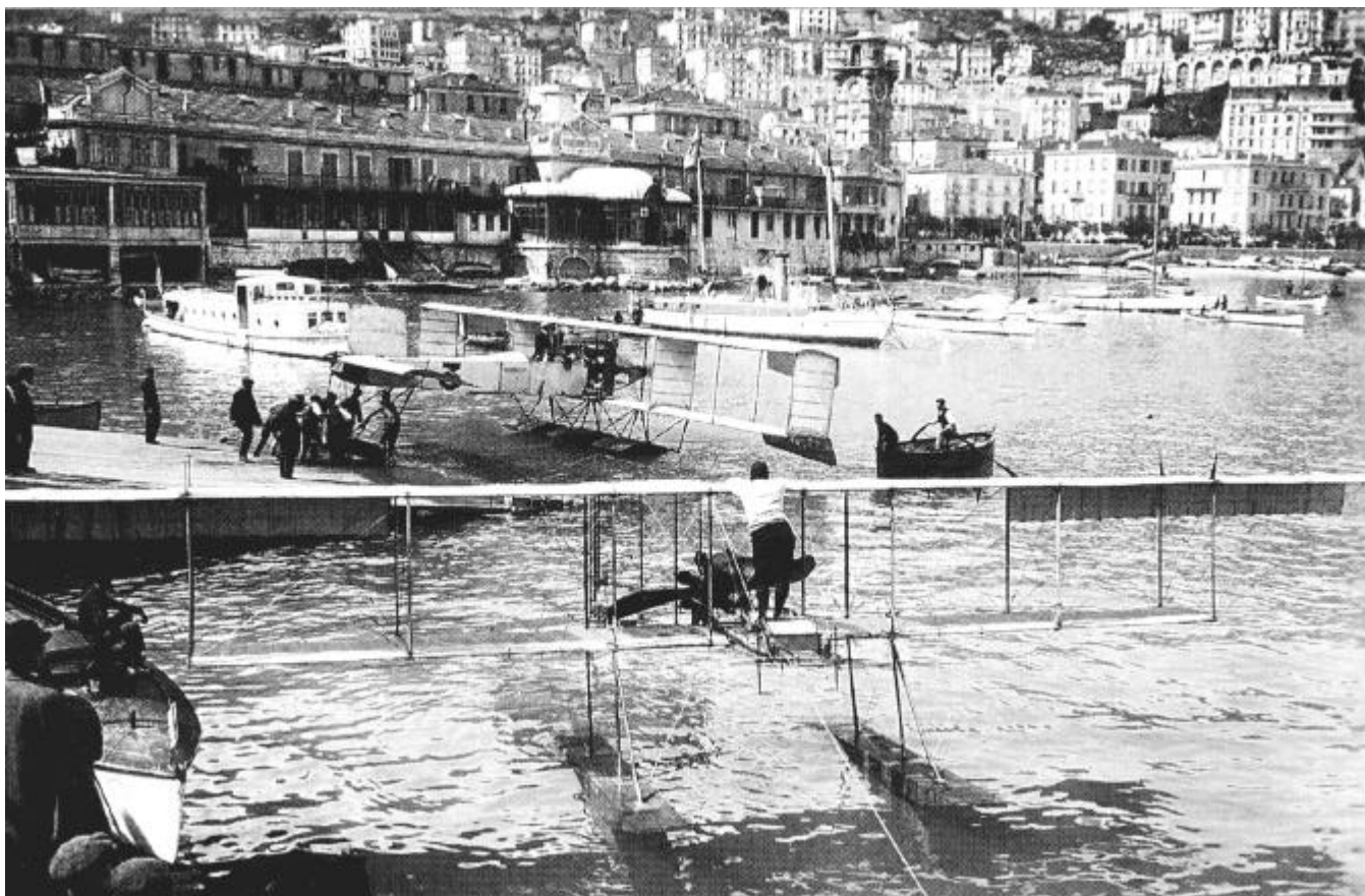
Le biplan HF-11 de Jules Fischer, au premier plan, masque le gros canard-Voisin de Maurice Colliex, au second plan. Notez sur l'appareil Henry Farman l'absence de fuselage ou nacelle et l'étroitesse des flotteurs. (Musée de l'Air).
