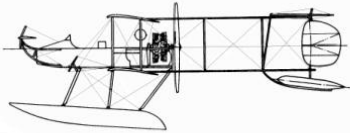
Dessiné fin 1913 par le génial Horace Short (1872-1917), âgé de 41 ans comme Henry Farman, très inspiré des biplans Farman, l'hydro S.80 Short « Nile » avec son stabilisateur avant. (Aeronautics).
