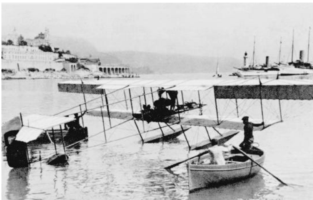
L'hydravion HF-11 à moteur Gnome 70 ch, vainqueur du meeting de Monaco 1912, piloté par Jules Fisher. (Musée de l'Air).
