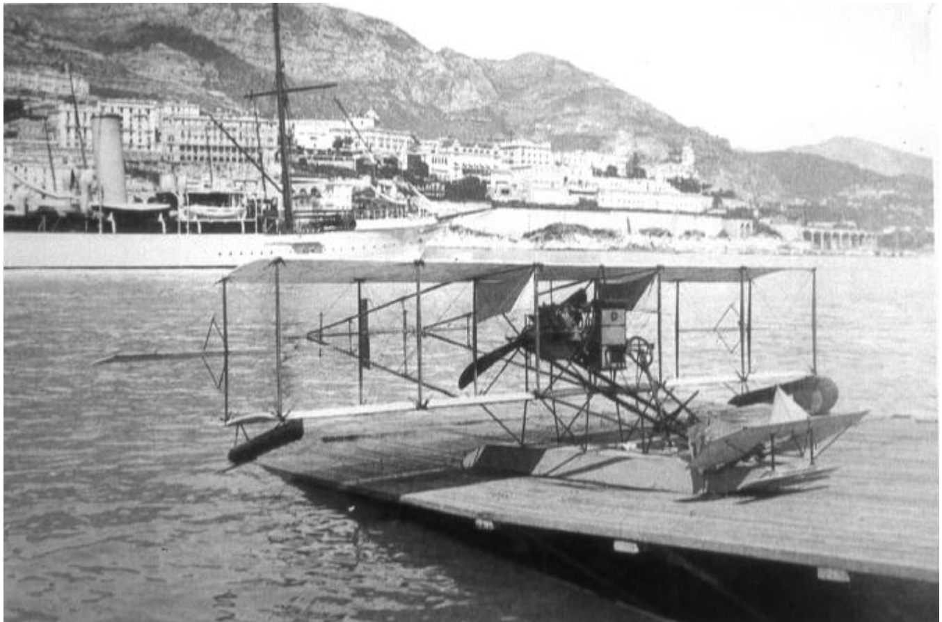
L'hydro monoflotteur sans redan Paulhan-Curtiss à Monaco en mars 1912 (SBM). Les passagers doivent s'asseoir sur le bord d'attaque du plan inférieur des ailes.
