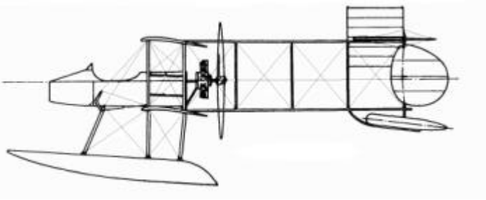
En janvier 1914, Horace Short, suivant la mode Farman, a supprimé le stabilisateur avant du S.80. Le résultat : l'un des plus beaux profils d'hydro d'avant guerre. (Aeronautics).
