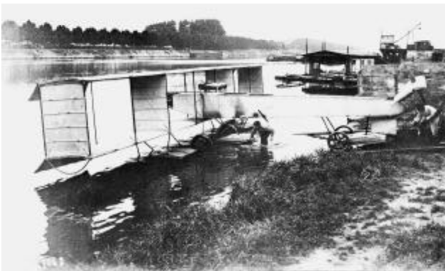
Le premier canard Voisin aux essais sur la Seine, muni de ses roues et flotteurs. (Cliché Musée de l'Air).
