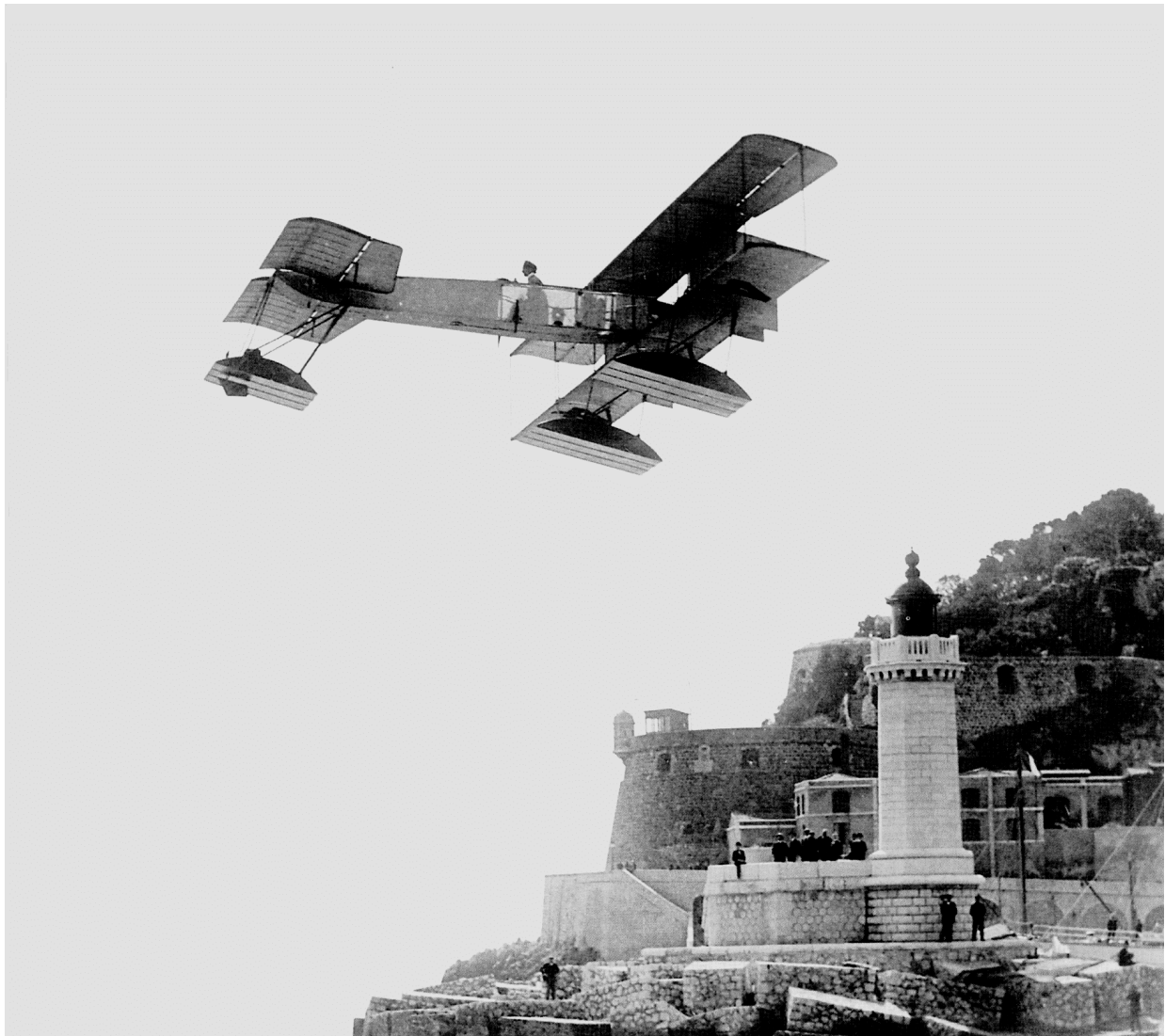
Le pilote Paul Rugère à Monaco en 1912 en plein vol sur le canard Voisin n° 4 à moteur Anzani 60 ch, un grand canard allégé d'un flotteur central à l'arrière et du stabilisateur vertical à l'avant. (Musée de l'Air).
