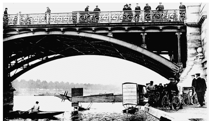
En juin 1911, Voisin expérimente sur la Seine au pont de Clichy son canard muni de flotteurs Fabre. (Cliché Musée de l'Air).
