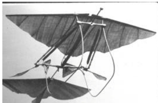
Planeur de Wilhelm Kress, 1877. Mu par un caoutchouc, il tient l'air une minute. (L'Aérophile).
