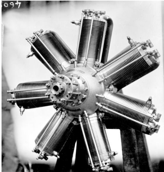
Moteur Clerget 7Y de 60 ch (1913). (Collection M-H Clerget).
