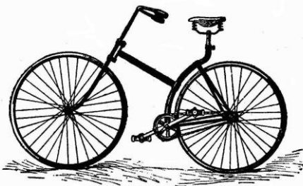
Bicyclette Clément à cadre droit, 1885. Les roues comportent encore des bandages en caoutchouc plein. (Faroussse 1902).
