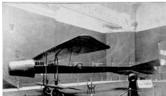
*Biplan à réaction Coanda à moteur Clerget 50 ch présenté au Salon de 1910. (Collection Clerget).*
