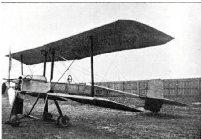
*Le Breguet III à train tricycle amorti, hélice tripale métallique Breguet à réducteur et moteur rotatif Gnome 50 ch (octobre 1909). (Musée de l'Air).*
