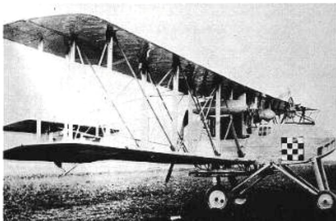
*Breguet-Michelin type B2 à moteur Renault de 200 ch (1916).*
