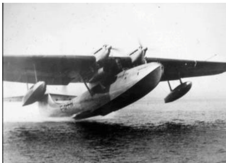
Photos du prototype, collection Violleau. Le déjaugeage trop cabré dénote un mauvais équilibre, une sous-motorisation ou une vitesse de décollage insuffisante.
