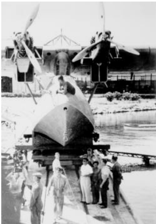
Le H-47 01 première version, avec radiateurs conventionnels. (Musée de l'Air).
