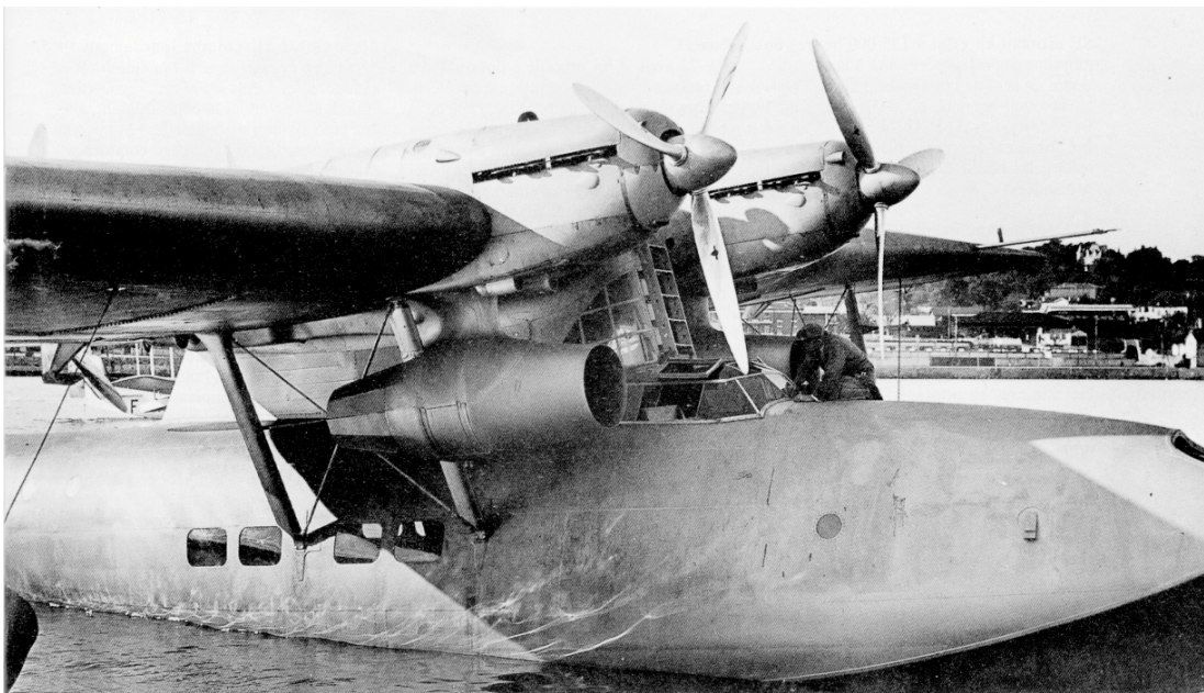
LeO H-47 01 modifié aux essais à Antibes (janvier 1937). Le très beau profil du Lioré et Olivier H-47 modifié montre ses nouveaux radiateurs aérodynamiques refroidis à l'éthylène glycol, contribuant à la propulsion de l'hydravion. L'étude aérodynamique du H-47 servira au SE-200. (Musée de l'Air).
