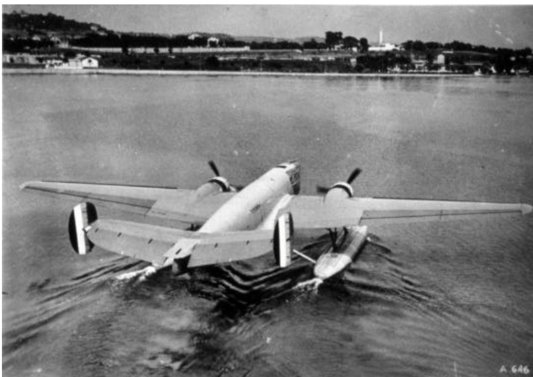
Le prototype LeO-46 aux essais en 1938. Il a reçu des cocardes, ses capotages Mercier et des moteurs Gnome & Rhône 14 N de 1060 ch. (Collection André Violleau).
