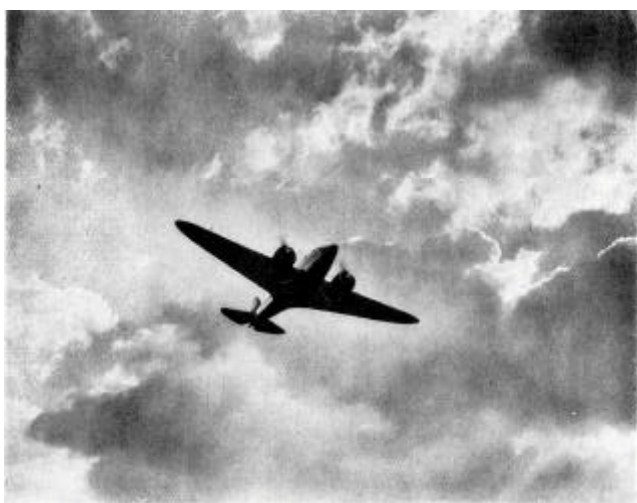
En 1936, plus aucun avion de ligne ou militaire ne possède de roues externes en vol. ( Les Ailes , 1936).
