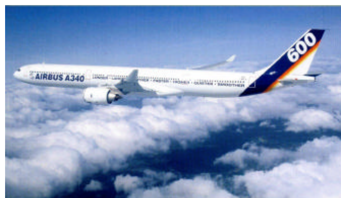
L'A340-600, demandé et financé en 1995, transportera 373 passagers sur 13 500 kilomètres. 1 er vol prévu en 1997 et livraisons en 2002. (EADS).
