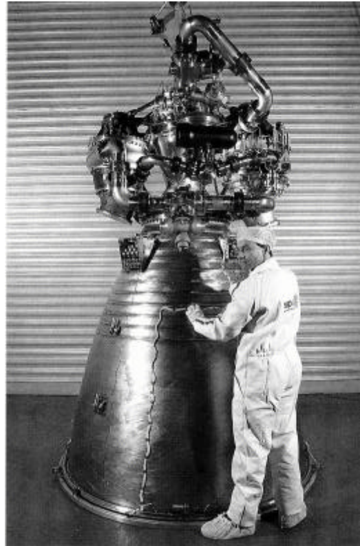
Moteur Snecma « Vulcain » visible aujourd'hui au musée des sciences de la Villette à Paris. Les premiers essais de mise à feu eurent lieu en 1990. (Snecma Moteurs).
