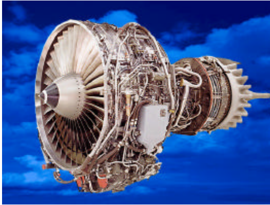
CFM56-5C, moteur exclusif du long courrier A340. (CFM International).
