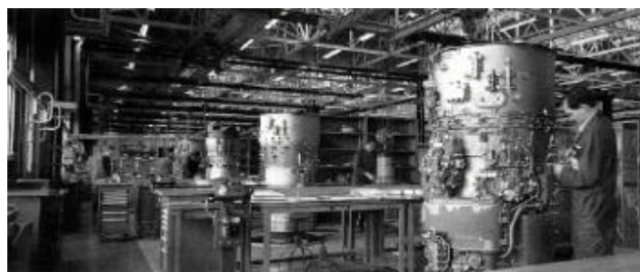
Atelier de montage des CFM56 à Villaroche. (Snecma moteurs).
