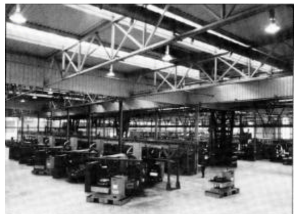
Inaugurée fin 1987 par le président de la République Français Mitterrand, l'usine Snecma du Creusot produit des pièces spéciales comme des disques de turbine pour toute la gamme CFM56. (Snecma Moteurs).
