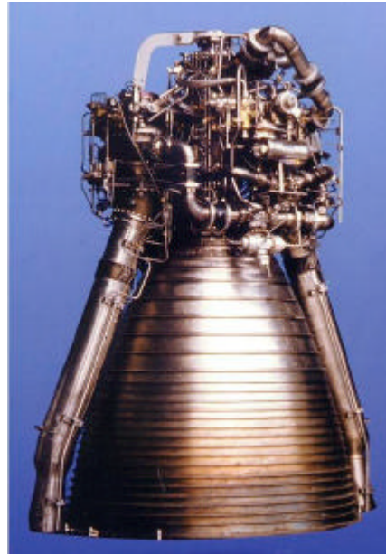
Moteur « Vulcain » II produit par la SEP (Snecma Moteurs).
