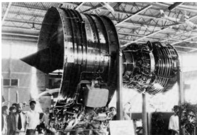
CFM56-5 en cours de montage à la Snecma, 1992. (Snecma moteurs).
