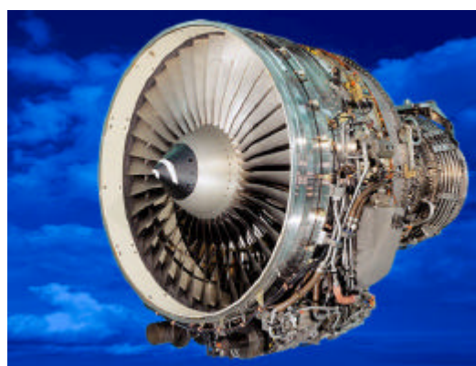
CFM56-5B développe jusqu'à 15 tonnes de poussée. (CFM International).
