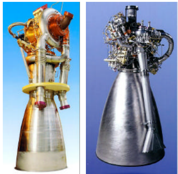
Moteur « Viking » des deux premiers étages de la fusée Ariane 4 et des PAL (boosters) d'Ariane 42L, 44L et 44LP, à gauche, et moteur HM7-B du troisième étage, à droite. (Sneema Moteurs).
