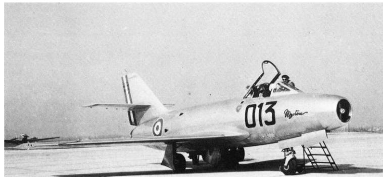
*Le Dassault MD-452 « Mystère » II à aile en flèche équipé du réacteur SNECMA Atar 101 vole à 1050 km/h. (Collection Lhérault).*
