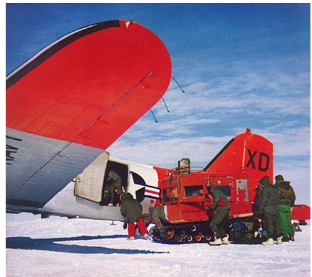
Appareil Douglas C-47 à skis utilisé dans l'Arctique et l'Antarctique. (US Navy).
