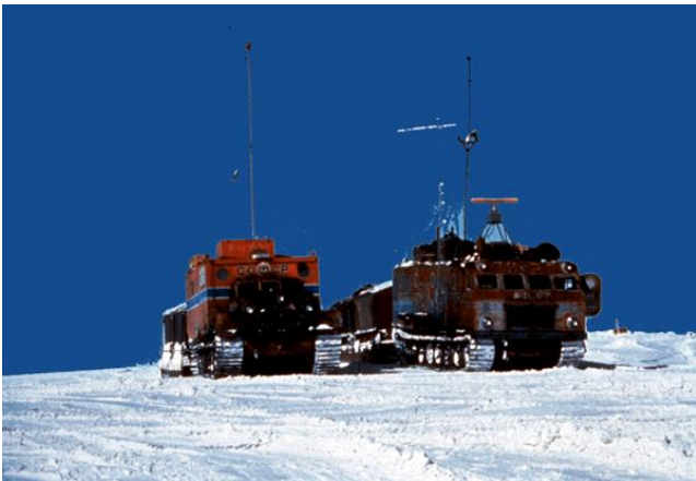
Les chercheurs de Vostok sont ravitaillés depuis la côte (Mirny) par des tracteurs de 100 tonnes qui parcourent à petite vitesse les 1400 km par des températures extrêmes. (Document français).
