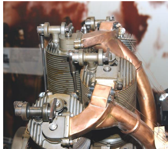
Gros plan sur le très beau moteur rotatif Gnome & Rhône 18-cyl de 340 ch d'origine Le Rhône. (Musée Snecma).
