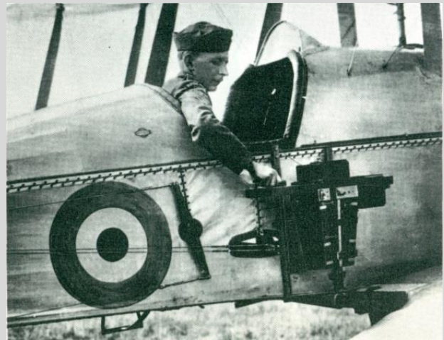
Avion du RNAS Royal Aircraft Factory BE2C équipé sur tribord d'un appareil photographique servant à identifier les bateaux. (RNA).
